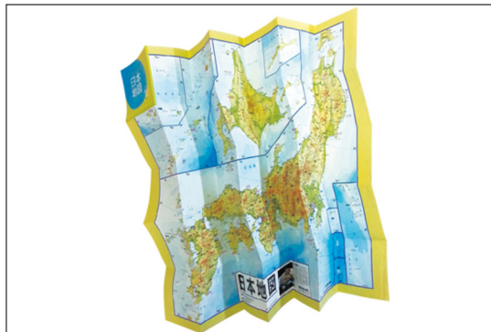
Il suffit de tirer sur le coin en haut à gauche et en bas à droite d'une carte pliée selon le miuraori pour la déployer en un clin d'œil (source : miuraori-lab )
